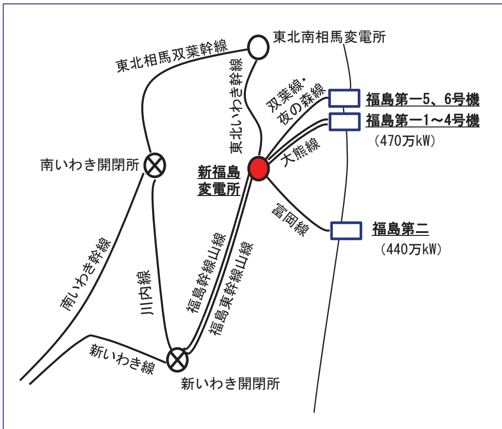
図 5. 3. 3-1 福島第一原発、第二原発への送電網 131
